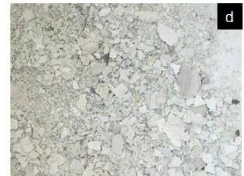
Figure III. 19: Étapes de la fabrication du blanc de plomb commercial issu d'un procédé d'empilement (a) : rouleaux de plomb métallique, (b) : strate de jarres contenant les rouleaux et prêtes à être recouvertes de fumier, (c) : rouleaux corrodes lors de l'ouverture des jarres après 4 mois de corrosion, (d) : pigment obtenu (on constate que le produit s'est détaché sous forme d'écaillles). © Natural Pigments
